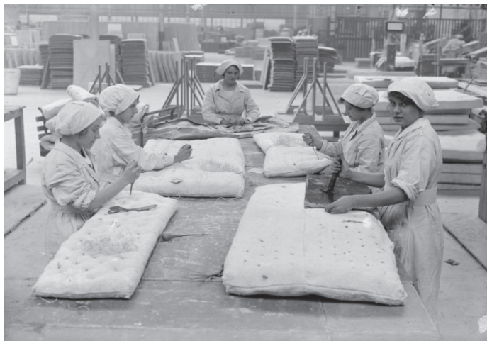
Рис. 4.9. Робітниці виготовляють матраци з азбестом на фабриці братів Тернер в парку Траффорд (Манчестер)
